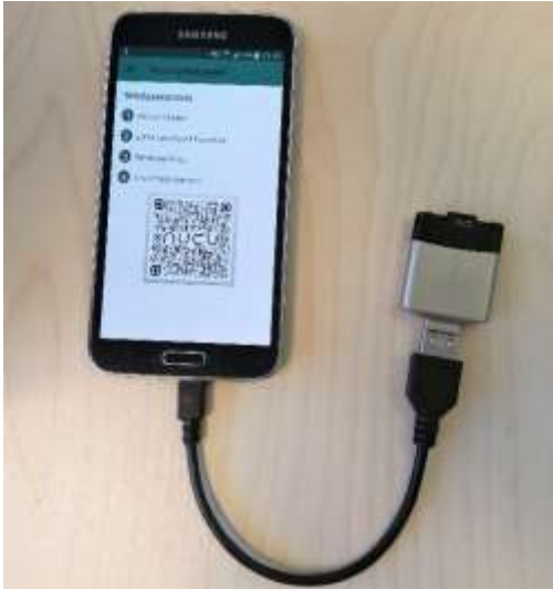
KUVA 21. SD-kortti kytketty Android-laitteeseen muistikortinlukijan sekä OTG-adapterin avulla
