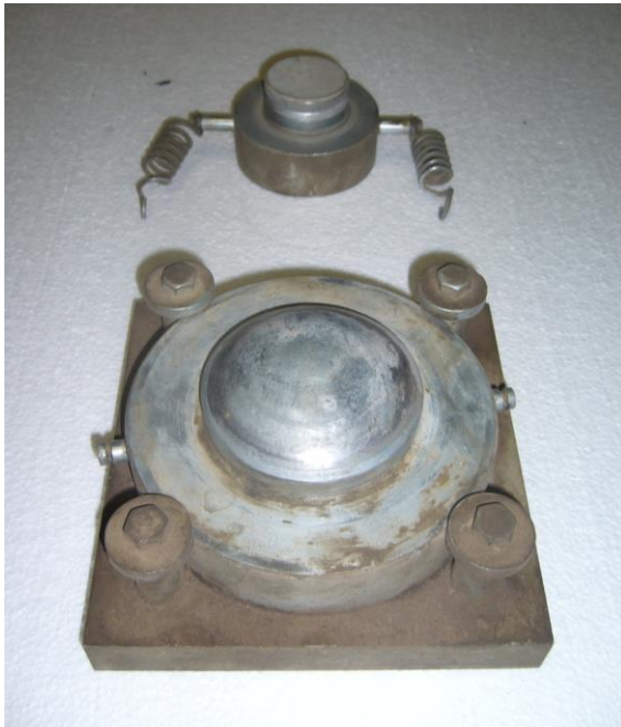
Kuva 4. Puristimen kalottinivelen yläosa (jouset), alaosa ja ylälevy.
