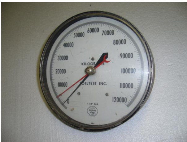
Kuva 6. Puristimen näyttö, jossa puristusvoima kilogrammoina, sekä normaali osoitin ja voimahuippuosoitin.
