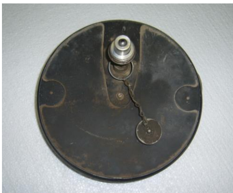
Kuva 7. Näyttö takaa. Ylempänä liitin, jolla näyttö liitetään kuvissa 1 ja 2 puristimen päällä näkyvällä liittimellä puristimeen.
