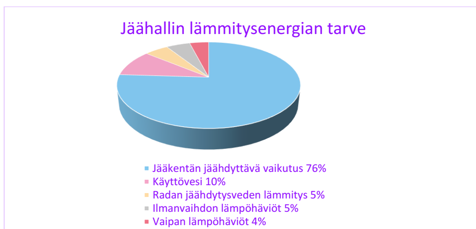
Kuva 7. Jääradan jäähdyttävä vaikutus on suurin lämmitystarpeen lisääjä. Jatkuva jäähdytys synnyttää lauhdelämpöä, jota voidaan käyttää tilalämmitykseen ja käyttöveden lämmittämiseen. (Jäähallien lämpö- ja kosteustekniikka, 2007, s. 97)
