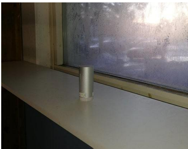
Kuva 48. Netatmo-sensorit mittasivat samaan aikaan lämpötilaa, suhteellista kos- teutta ja hiilidioksidipitoisuuksia.
