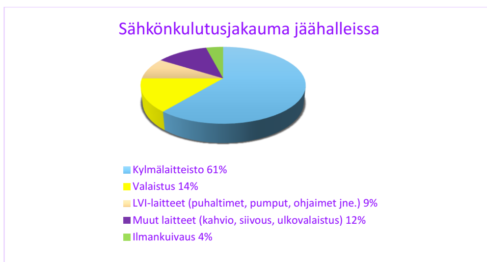
Kuva 6. Kylmälaitteisto on suurin sähkönkuluttaja jäähallissa. Jäärataa palvelevan valaistuksen osuus jäähallin sisävalaistuksen sähkönkulutuksesta on n. 85 %. (IIHF, 2016)
