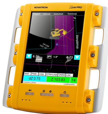
Kuvio 8. Koneohjausjärjestelmän ohjaamoon sijoitettava päätelaite. (Xsite Pro 3D n.d.)
