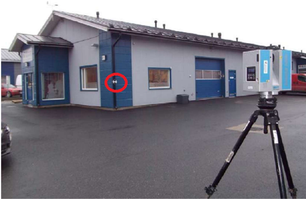
Kuvio 2. Laserkeilain ja seinälle kiinnitetty tähys ympyröitynä punaisella (Ahonen 2015, 24.)
