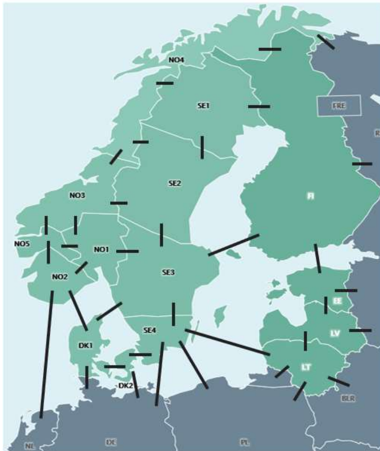
Kuvio 1. Nord Poolin tarjousalueet ja niiden väliset siirtoyhteydet (Market data n.d., muokattu)
