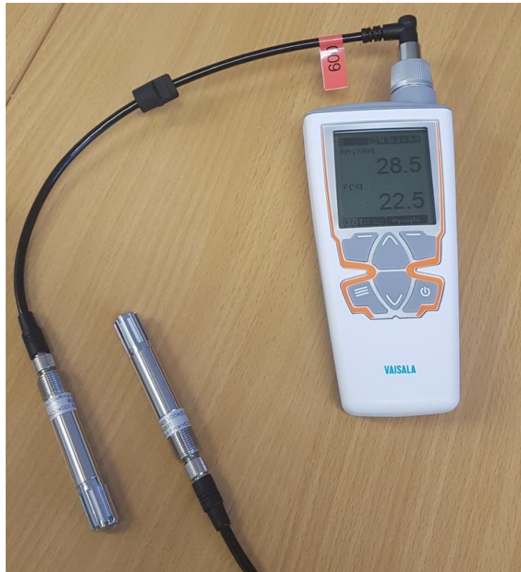
Kuva 1. Vaisala-mittalaite betonin suhteellisen kosteuden mittaamiseen.
