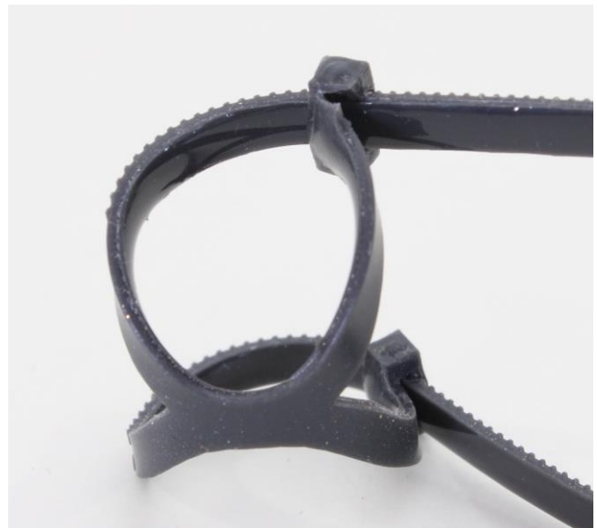
KUVA 35. Hajonnut mittaväline Flexible-hartsista (Korhonen 2018.)
