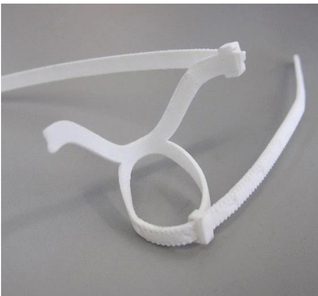
KUVA 34. Hajonnut EOS-tulostettu mittaväline (Korhonen 2018.)
