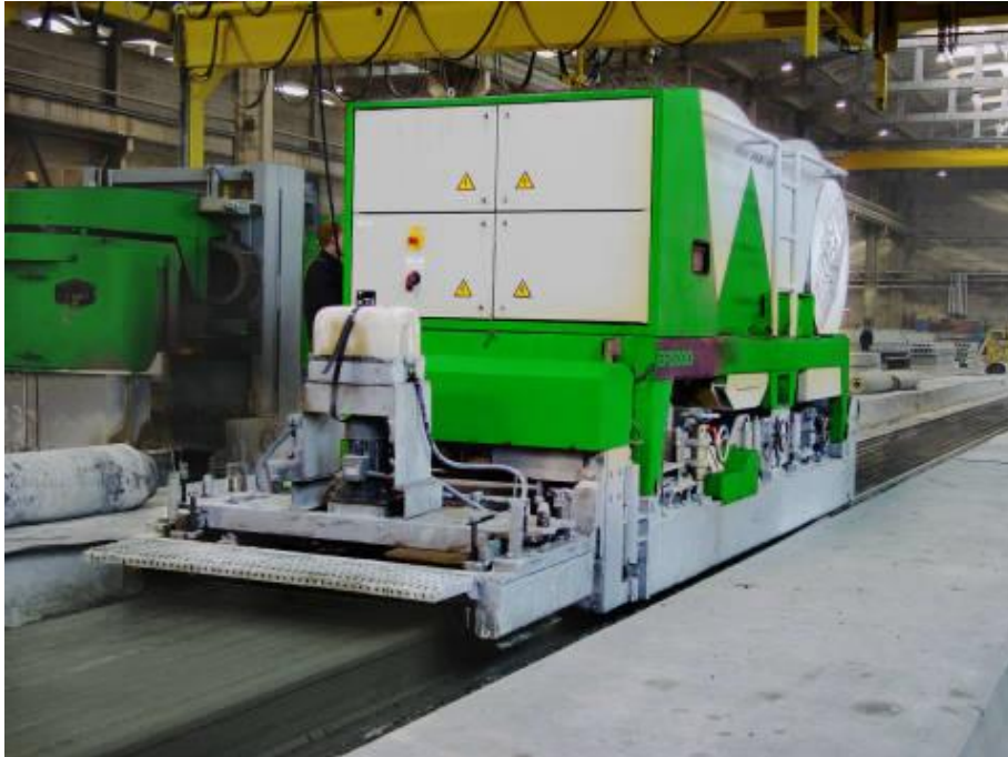
Kuva 2. Ontelolaattojen valmistuksessa käytetty suomalaisen Elematicin valmistama P7-1200s -liukuvalukone. [Elematic Oyj, www.elematic.com , kuva haettu 20.02.2019]
