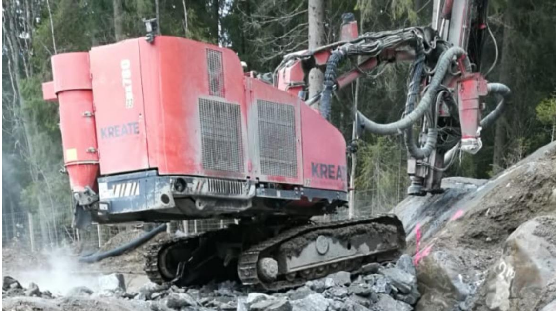
Kuva 15. Sandvik DX780 poravaunu
