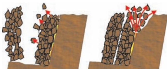
Kuva 32. rivikohtaisen hidastuksen vaikutus kivien sinkoiluun [www.oricaminingsservices.com,]
