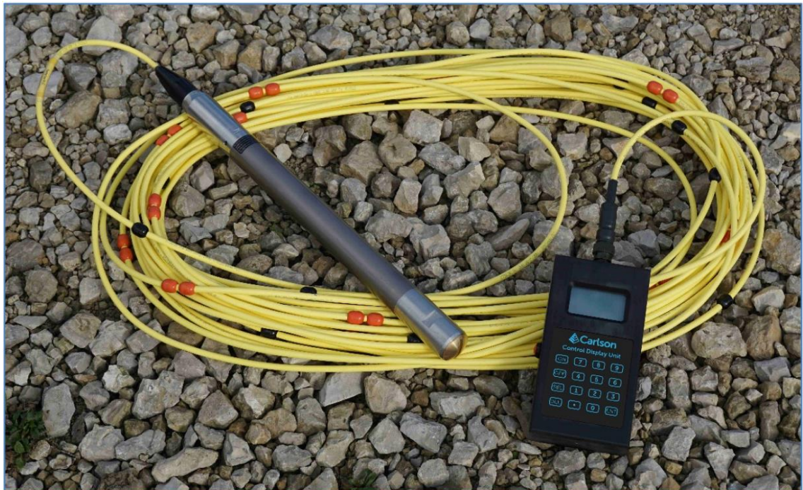
Kuva 27. Carlson Boretrak Cabled -reikäsuoruusmittari [www.carlsonsw.com.]
