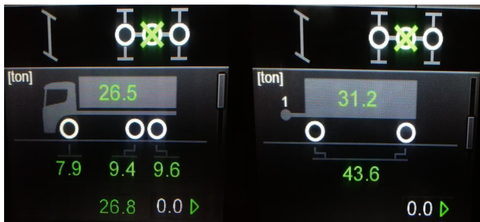
Kuva 9. Kuormapainon seuraaminen ajotietokoneesta kuormaustilanteessa. (Heikkinen 10-02-2019)
