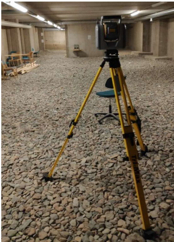
Kuvio 8. Keilaintakymetrillä mittaus lasilevyelementin läpi liittospisteelle
