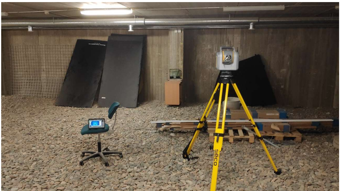
Kuvio 9. Mittauskokeissa käytetty keilantakymetri Trimble SX10 sekä maastotalennin
