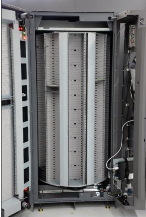
Kuva 5. Uudentyyppinen karuselliautomaatti. (Walter Tools 2019).
