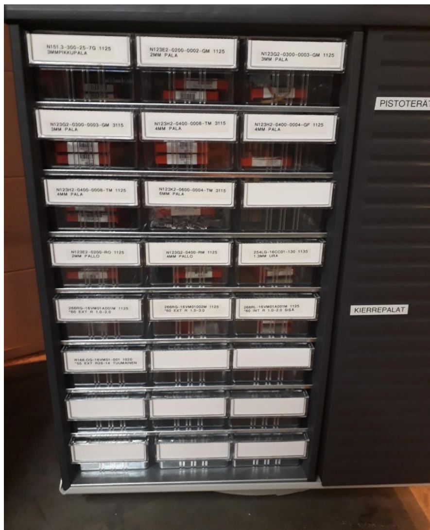
Kuva 20. Pisto- ja kierrepalojen osasto.
