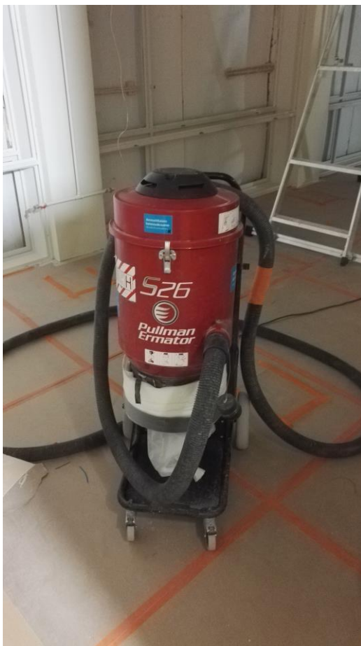
Kuva 8. HEPA13-suodattimella varustettu teollisuusimuri.
