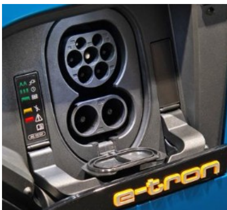
KUVA 13. CCS Combo vastakappale Audi e-tronissa (Zap-Map 2019)
