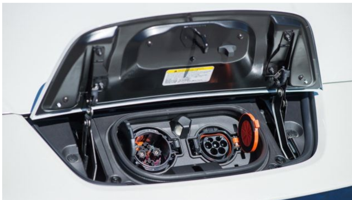
KUVA 16. Uudemman korimallin Nissan Leafin vastakappaleet CHAdeMO pikalataukselle sekä tyypin 2 AC-lataukselle (Moottori 2018)
