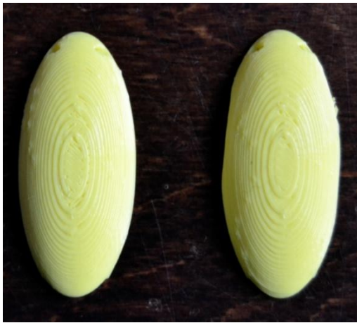
Kuva 9 Suomuja. Vasen ilman tukirakenteita, oikea tukirakenteilla (Lindh 2019)
