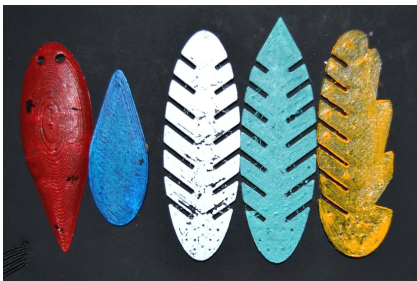
Kuva 58 Maalauskoekilut NinjaFlexilla. Vasemmalta oikealle: 1. Akryyli maali 2. Gesso ja akryyli maali 3. Spraymaali, 4. Spraymaali ja akryyli maali 5. Öljy maali (Lindh 2019)
