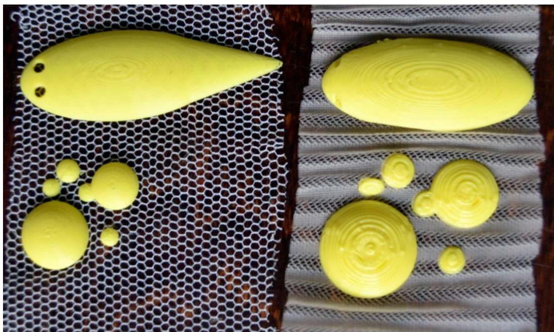
Kuva 35 Hieno vs. normaali tulostuslaatu. Vasemmalla on hieno, oikealla normaali tulostuslaatu. (Lindh 2019.)
