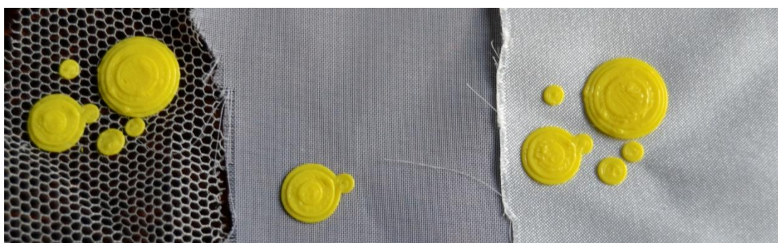
Kuva 2 3D-tulosteet tyllin, sifongin ja satiinin pinnalla (Lindh 2019)
