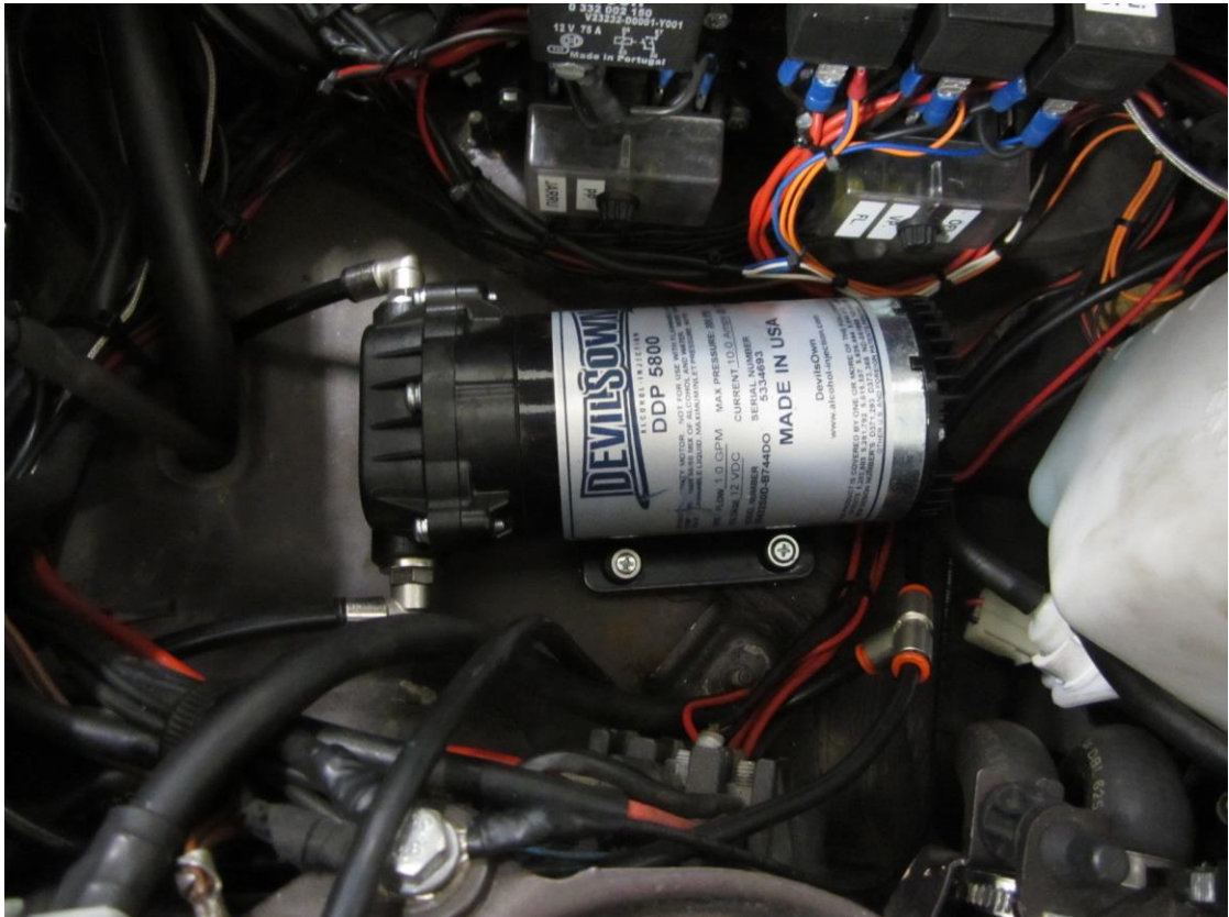
Kuva 6. Korkeapainepumppu sijoitettuna kohdeajoneuvon akkutilaan.
