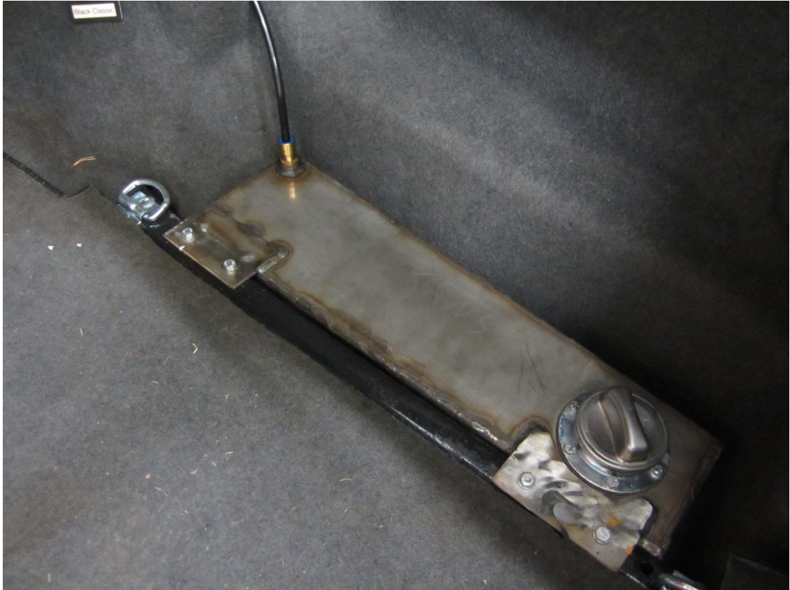
Kuva 8. Nestesäiliö asennettuna kohdeajoneuvon tavaratilaan.
