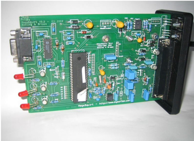
Kuva 6. MegaSquirt-polttoaineen ruiskutuksen ohjain valmiina
