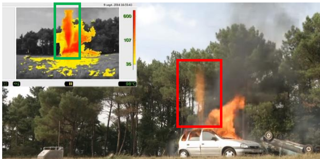
Kuva 14: Polttokennoajoneuvon palossa vetysäiliön lämpösulakkeen kautta purkautuva pistoliekki (YouTube).
