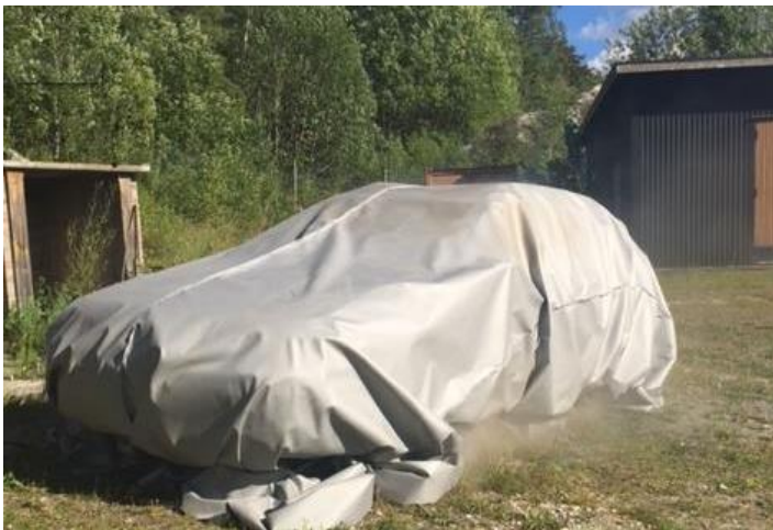
Kuva 7: Ajoneuvon sammutuspeite, palava ajoneuvo käärittynä peitteeseen (Tamrex).
