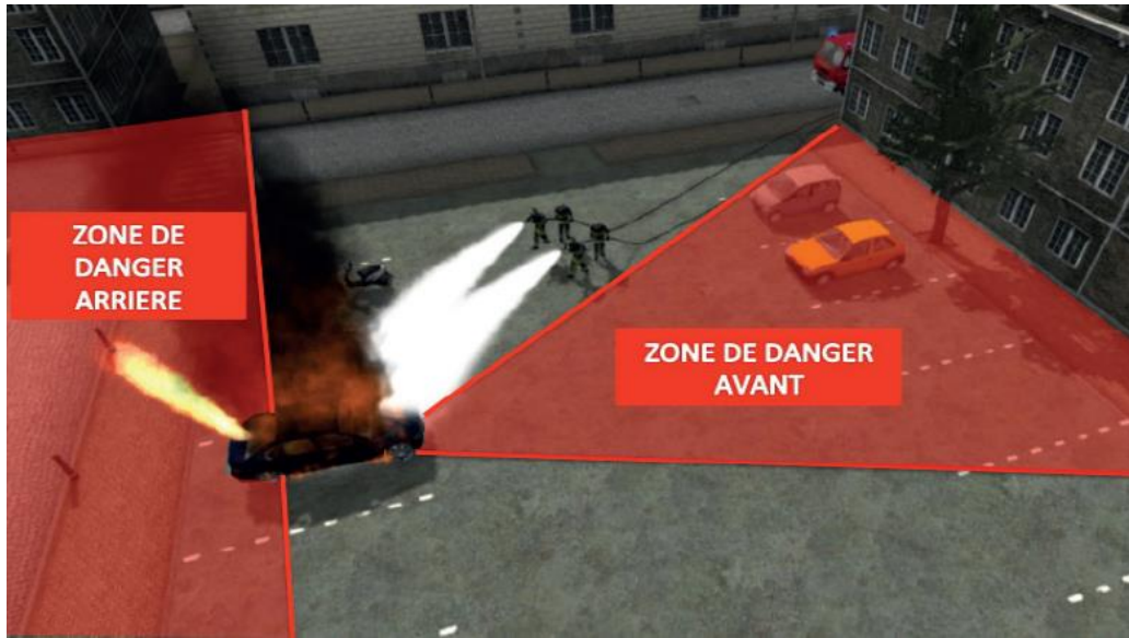
Kuva 13: Kaasuajoneuvon palossa turvallinen työskentelyalue sekä vaara-alueet (Palo-kunnan toimintakäsikirja 2018, 51).
