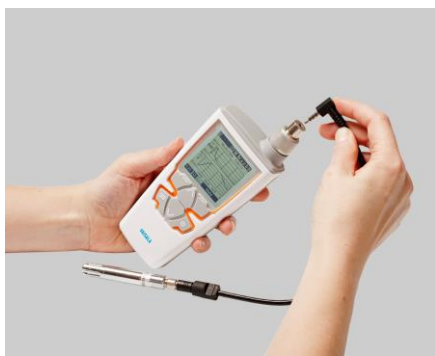
Figur 6 Vaisala HM40 mätinstrument och HM40S mätprob. (Vaisala HM40 datasheet, u.d.)
