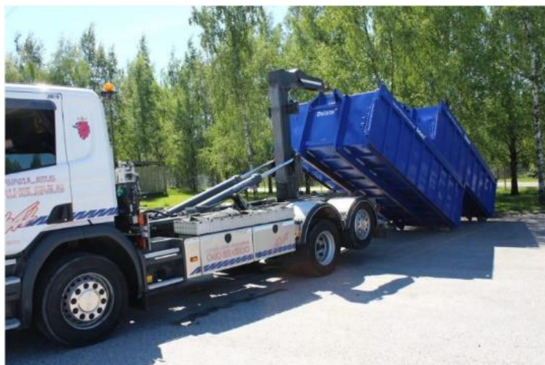
Kuva 4. Deleten päällekkäin pakattava kuormalavajärjestelmä. (Delete 2016)
