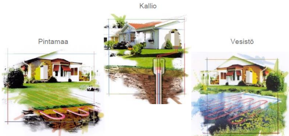
Kuva 3. Keruuputkiston vaihtoehdot maalämpöpumpulle (Sulpu, Yleistä lämpöpumpuista, [Viitattu 2.2.2019]).
