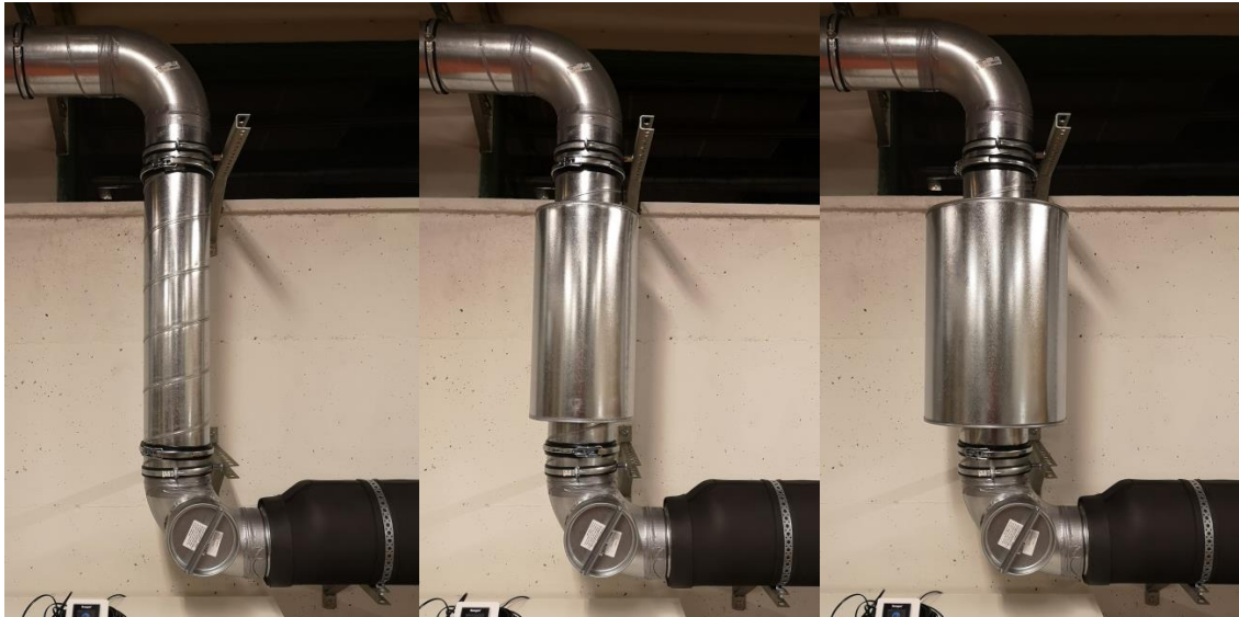
Figur 29. Ljuddämpningslösningen med de olika utbytbara alternativ.
