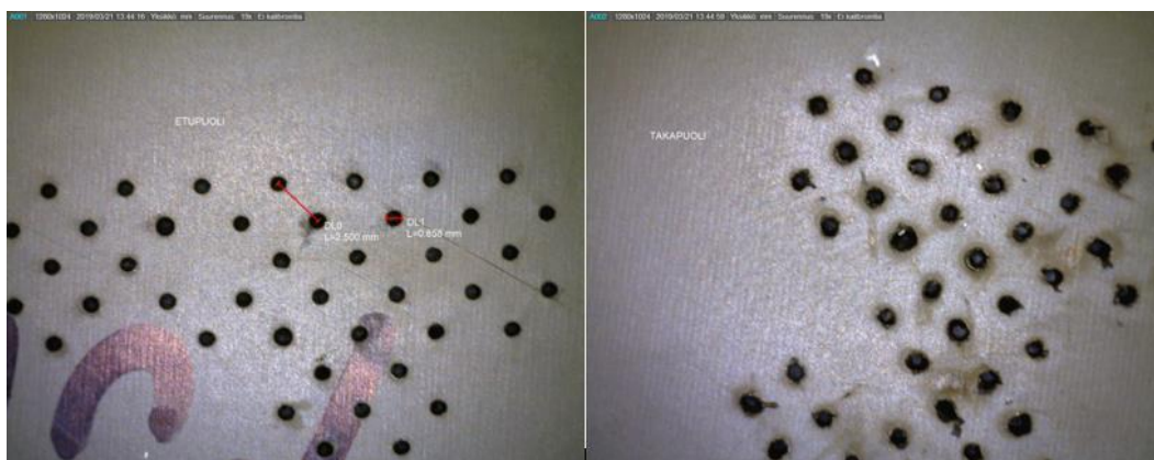
Kuva 7. Alumiinilevyjen koeporaukset etu- ja takapuolelta. /24/
