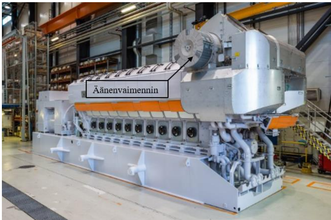
Kuva 2. Äänenvaimentimen sijainti Wärtsilä 31SG -moottorissa. /25/
