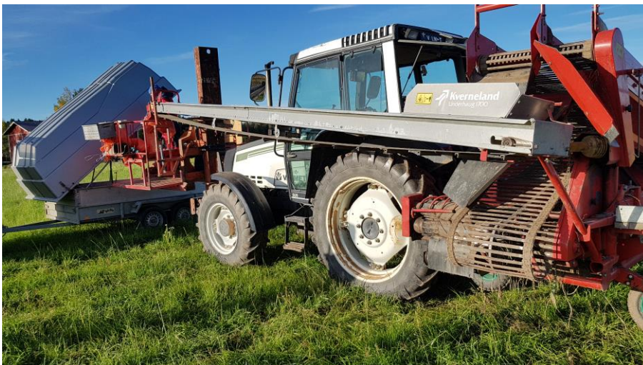
Bild 10. Bilden visar hur upptagare, transportband och korg är monterad på traktorn. (Nylund 2018)
