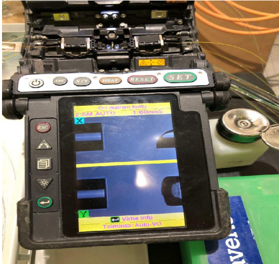
Kuva 15. Vasemmalla on nähtävissä onnistunut leikkaus, oikealla epäonnistunut.
