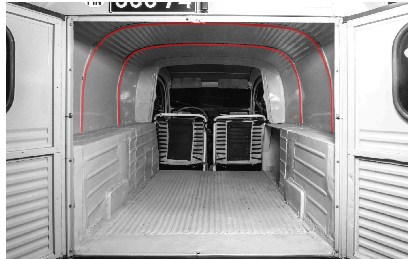
Katon tukirakenteet korostettu punaisella
