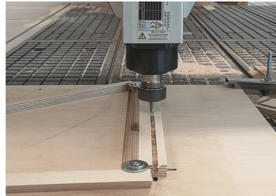
CNC-sorvi leikkaamassa välilevyjen palikoita
