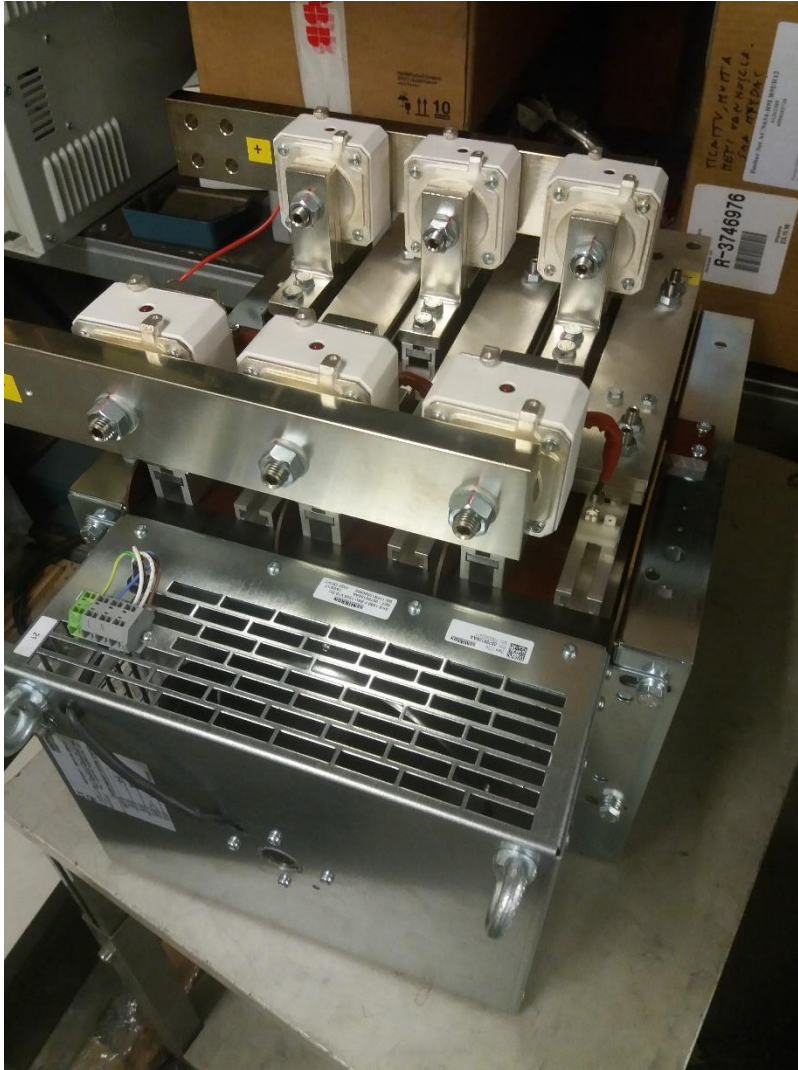
KUVA 5. Semikron SKS-1950F-B6U-1305-V16-ZU –tasasuuntaaja
