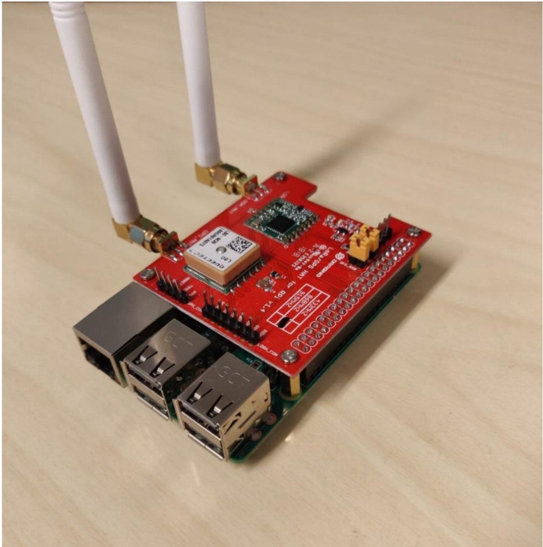
KUVA 1. Raspberry Pi 3B+, jossa Dragino LoRa -lisäosa
