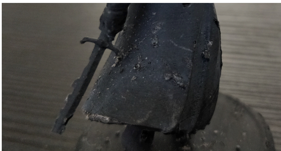
Kuva 59. Tukirakenteiden jättämiä epätasaisuuksia miekassa ja mallin pinnassa.
