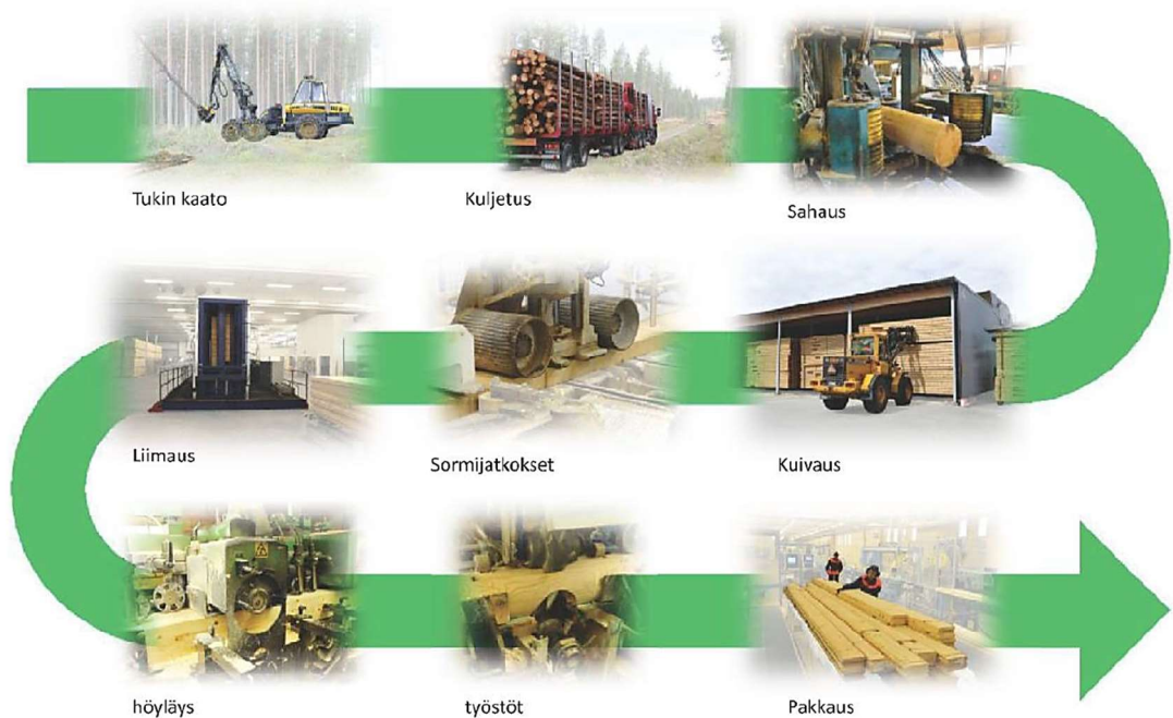
Kuva 1. Lamelli-hirsien tuotannon prosessikaavio. Kontiotuote Oy
