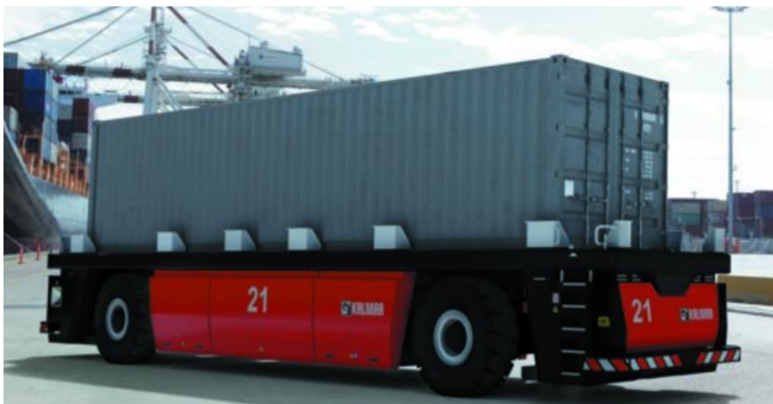
Kuva 18. Täysin automaattinen kuljetusvaunu Kalmar FastCharge AGV (Kalmar 2018.)
