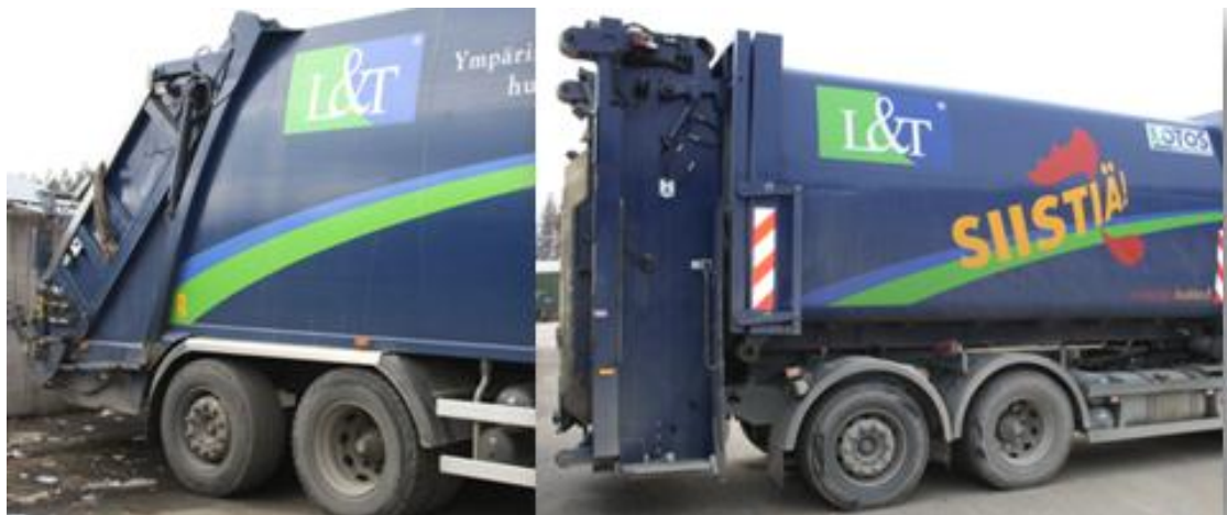
KUVIO 6. Normaalin takalastaajan ja lotos-jäteauton perät
