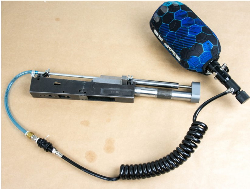
KUVA 39. Paineilmasäiliö liitettynä rekyylikoneistoon
