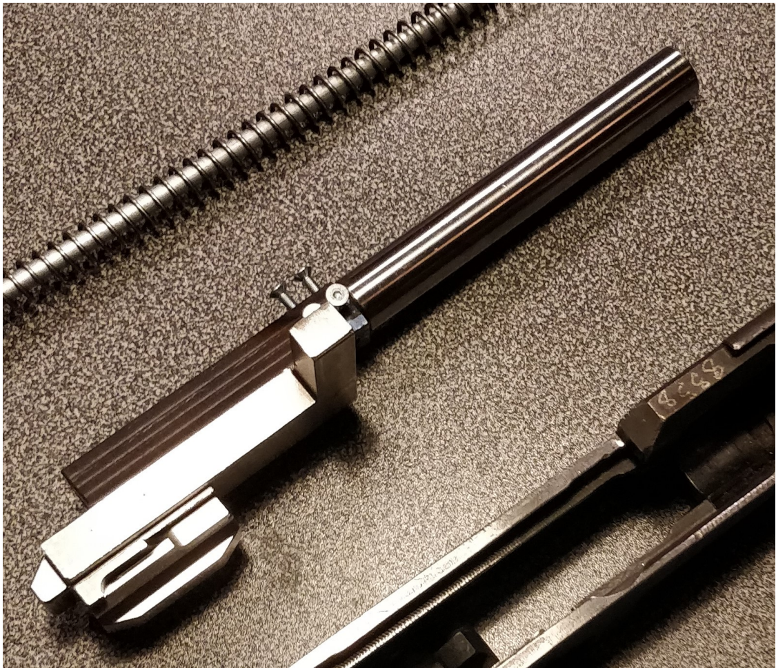
KUVA 33. Luisti ja siihen vararatkaisulla kiinnitetty luistin putki
