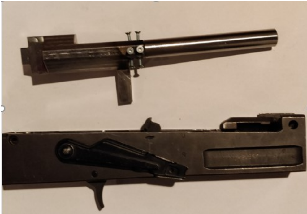
KUVA 36. Luisti ja laukaisukoneisto asennettuna runkoon
