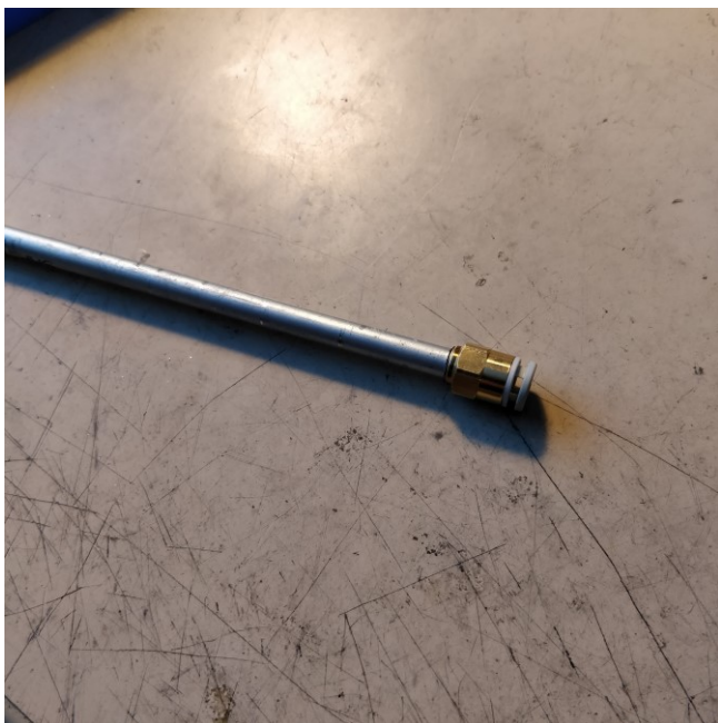
KUVA 38. Pistoliitin liitettynä luistin karanputken päähän.
