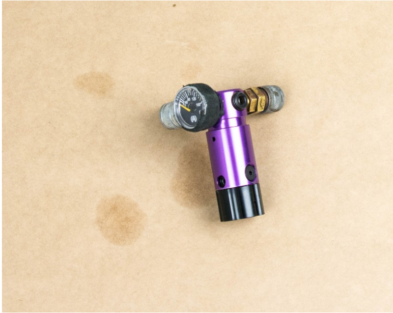
KUVA 40. Paineilmasäiliön ja letkun väliin asennettava lisäregulaattori
