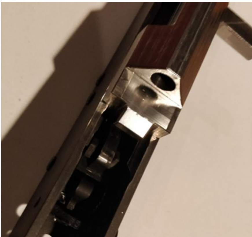
KUVA 37. Luistin yhteensopivuuden testaus laukaisukoneiston kanssa.
