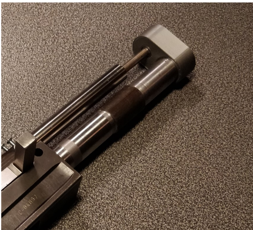
KUVA 29. Ulkopiippu kiinnitettyä runkoon
