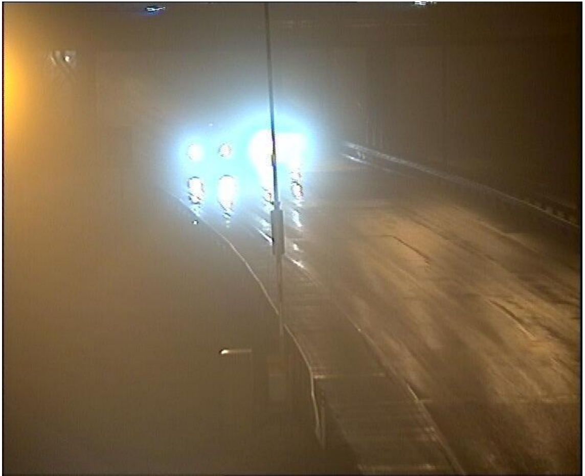
Kuvio 8. Hämärässä otettu kuva. Vaisalan tienpinta-anturin mukaan tienpinta on märkä, mutta kuvaa katsoessa tätä on mielestäni mahdotonta varmuudella sanoa. (Wirma 2019.)
