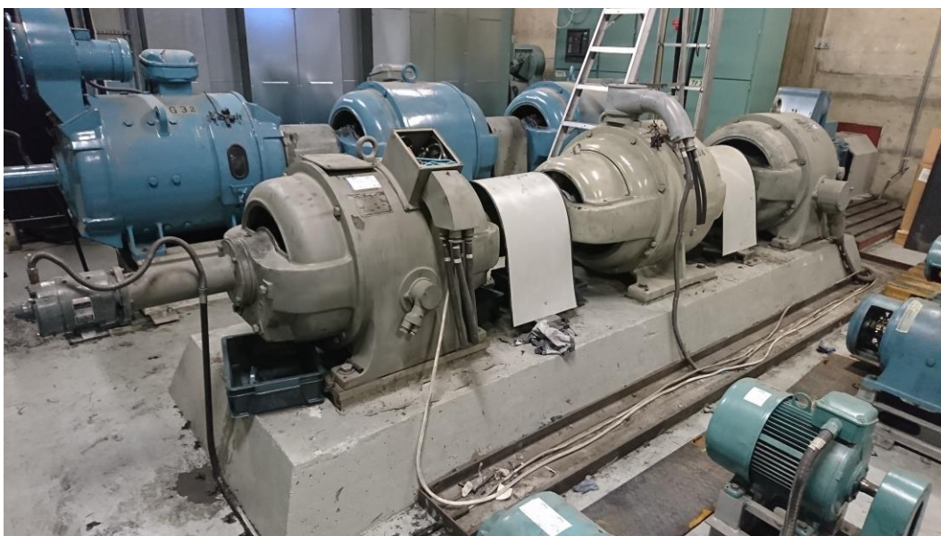
Kuva 1. Kuvassa vasemmalta oikealle: Generaattori G4, tasavirtakone G34 ja vetomoottori M4.
