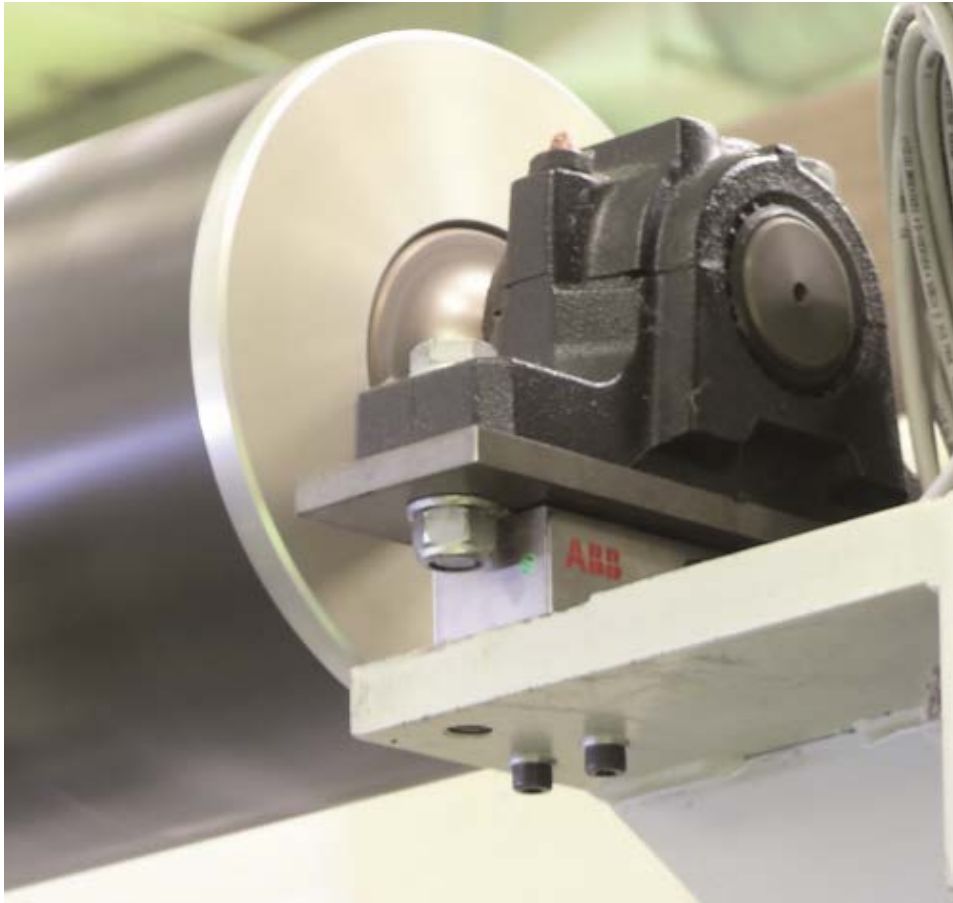
KUVA 40. Pillow Block – anturin perinteinen asennustapa
