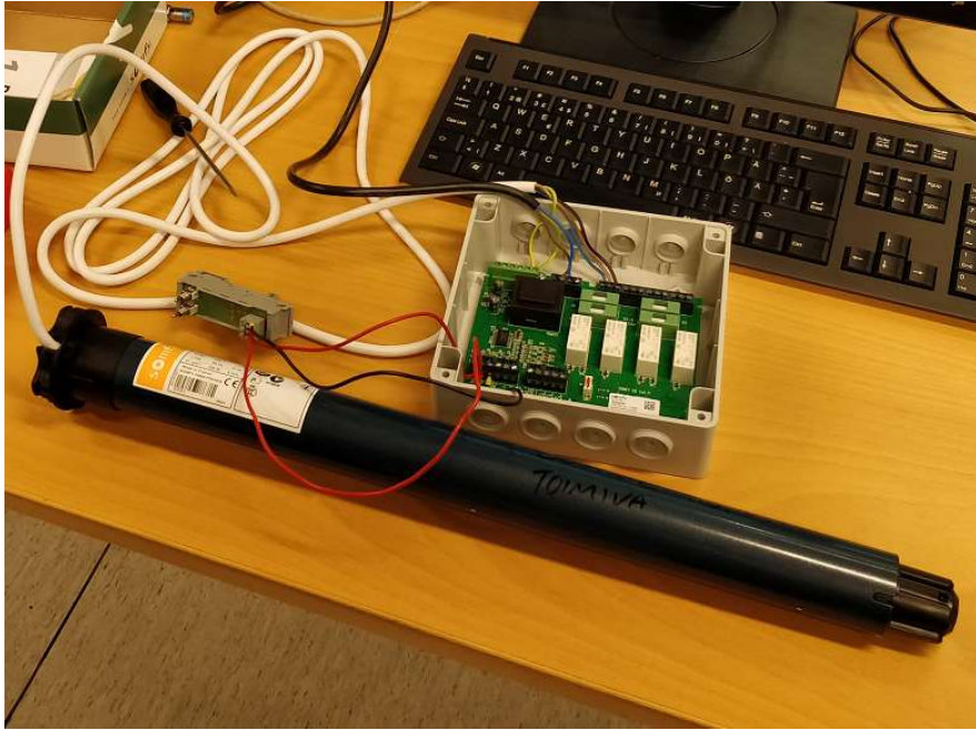
Kuva 17. Somfy LT50 verhomoottori ja IB4 laboratorio testissä.
