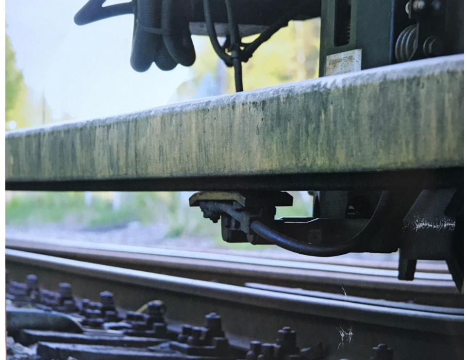
Kuva 21. M200-sarjan virroitin koskettaa virtakiskon alapintaa. Kuva: Markku Laaksonen
