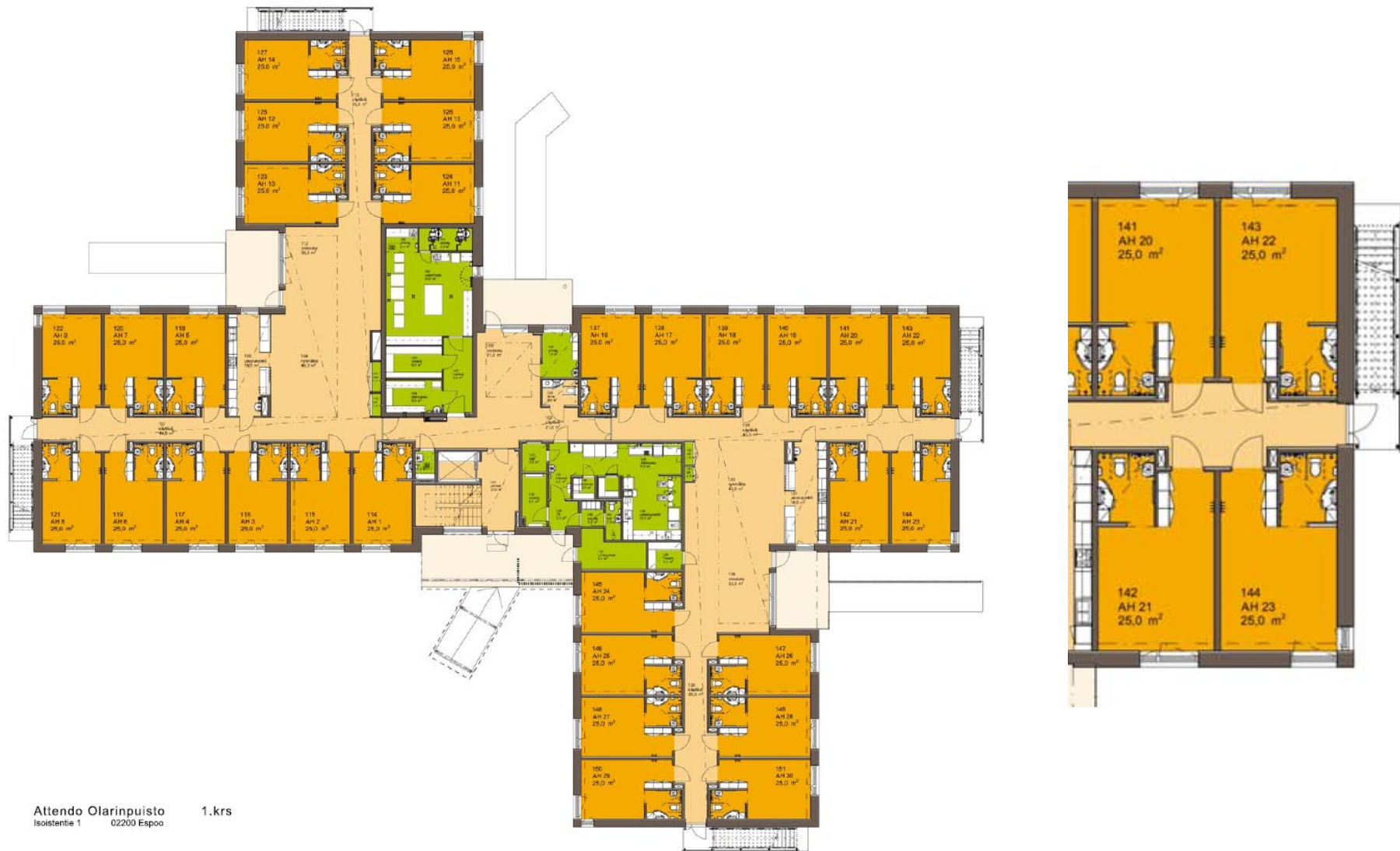
Kuva 9. Attendo Olarinpuiston hoivakodin 1.krs pohjapiirustus. ja pohjaote ryhmähuoneista. Hoivakodissa yhdistetään omiin siipiinsä sijoitetut ryhmäkodit yhdeksi kokonaisuudeksi. (Attendo, 2015)
