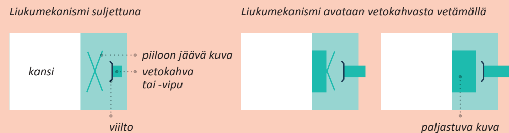
Kuva 17. Esimerkki liukumekanismista. Vetokahvaa vetämällä paljastuu kannen alla piilossa ollut kuva. Piirros perustuu Hinerin (2004, 32) ja Birminghamin malleihin (2006, 70).
