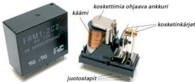
Kuva 16 Sähkömekaaninen rele (Haiko 2013)
