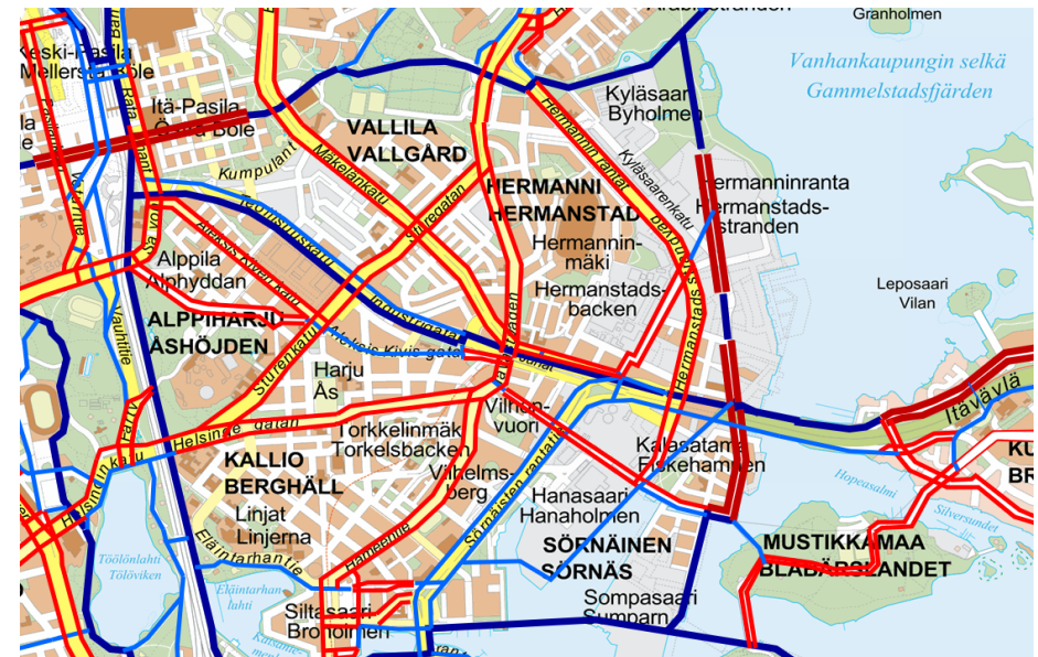
Kuva 21 Pyöräilyn tavoiteverkon haamolte ma noudattaa Stravan lämpökarttaan piirteitä reittejä. Tumma sininen viiva on kaksisuuntainen pyörätie, vaalea sininen yksisuuntainen. Punaiset viivat ovat yksisuuntaisia pyöräkaistoja katujen reunoissa.
