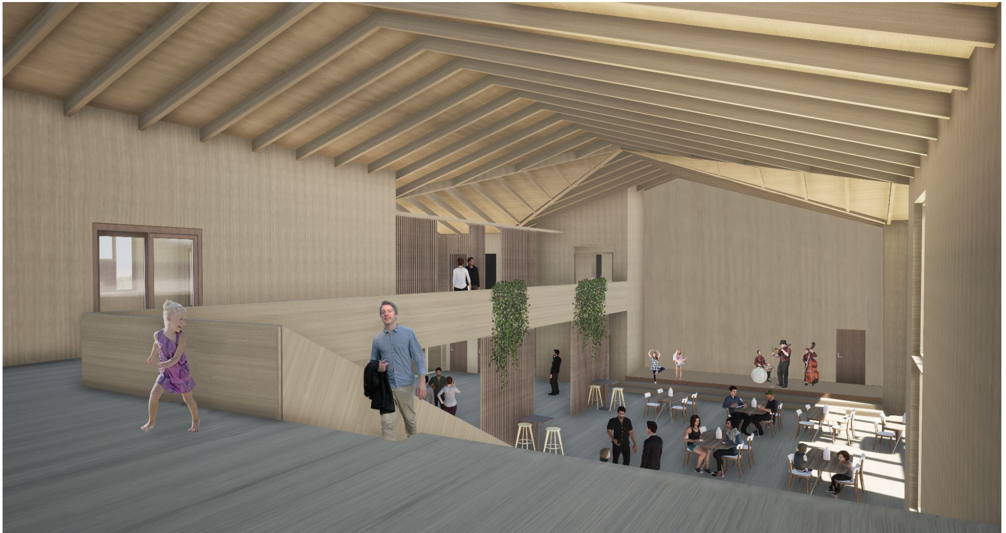
Kuva 60 Havainnekuva 2. kerroksesta monitoimisaliin. Kattopalkit ovat näkyvä osa sisätilaa.
