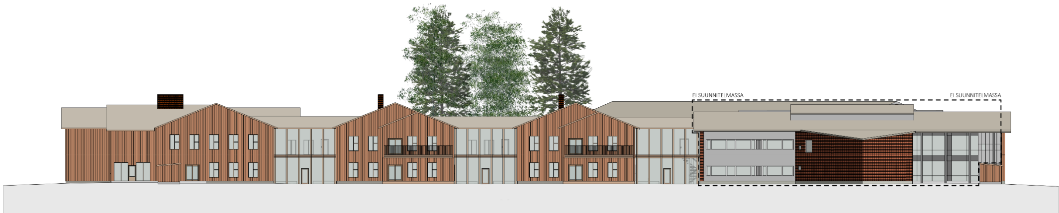
Kuva 64 Julkisivu etelään. Oppimistiloina olevien parvekkeiden alla ovat luokkien terassit. Suunnitelmaan kuulumaton alue merkittynä katkoviivalla. 1:500
