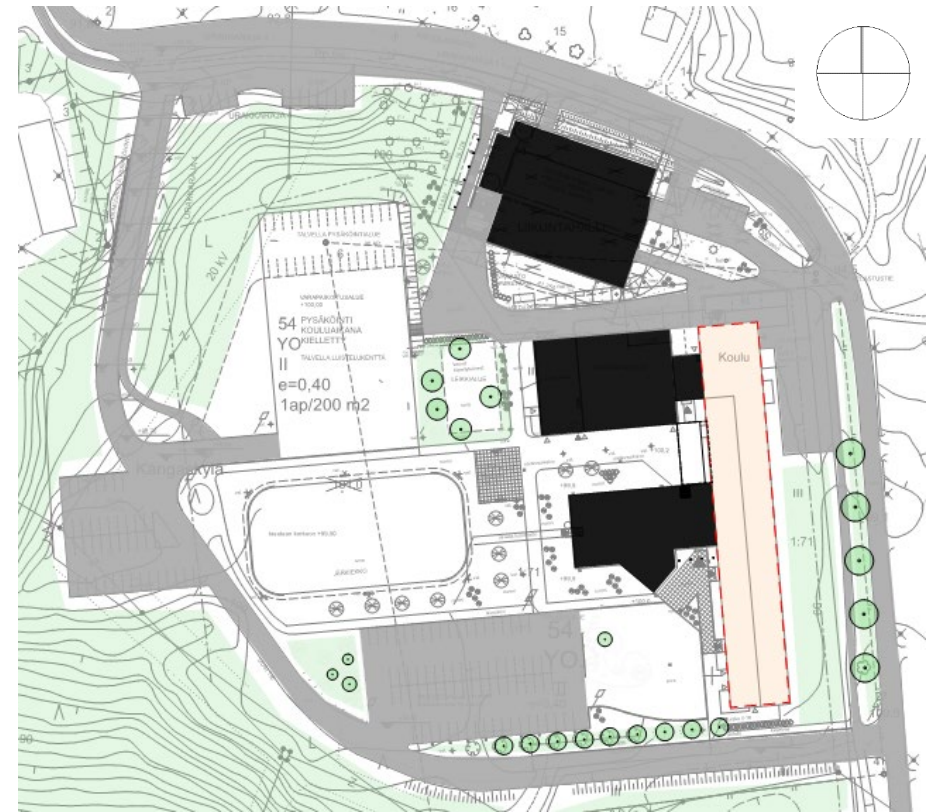
Kuva 36 Lähtötilanne, jossa asfaltoidut liikenneväylät harmaalla ja purettava rakennusosa punaisella. (Taustan kuva: Parikkalan kunta, tekniset palvelut 2018)
