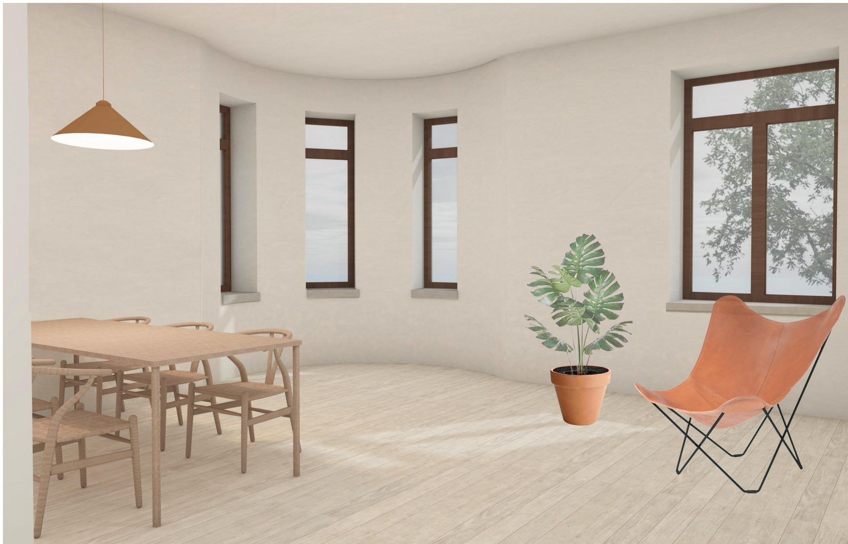
Kuva 78. Toisen kerroksen lattia palautetaan lausalattiaksi ja ikkunalaudat teräshierretylle betonipinnalle. Seinä- ja kattopinta käsitellään kalkkimaalilla.
