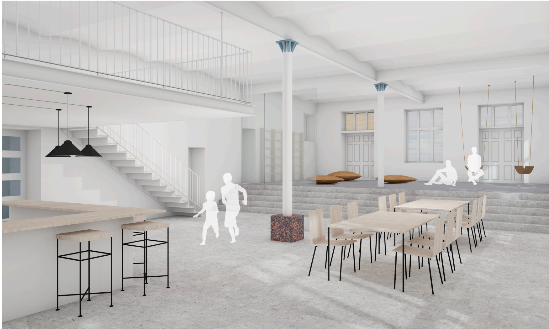
Kuva 75. Parvi muuttaa tilan mittakaavaa oleskelulle miellyttäväksi. Salin pääsisäänkäynti sijoittuu parven alle, jolloin tila avartuu peremmälle astuttaessa.
