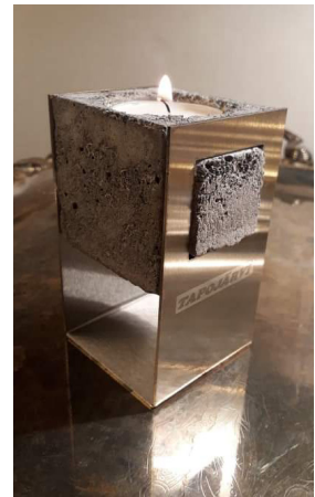
Kuva 1. Kuonabetonista valmistettu geopolymeeria sisältävä ”Tuikku”.
