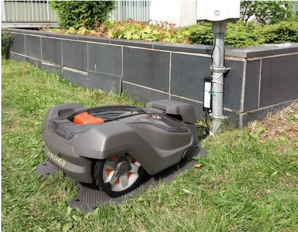
Kuva 5. Robottiruohonleikkuri latautumassa asemassaan Espoossa ja tolppaan kytketty muuntaja.
