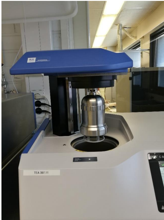
Kuva 3. Pommi kiinnitettynä kalorimetriin juuri ennen mittausta.
