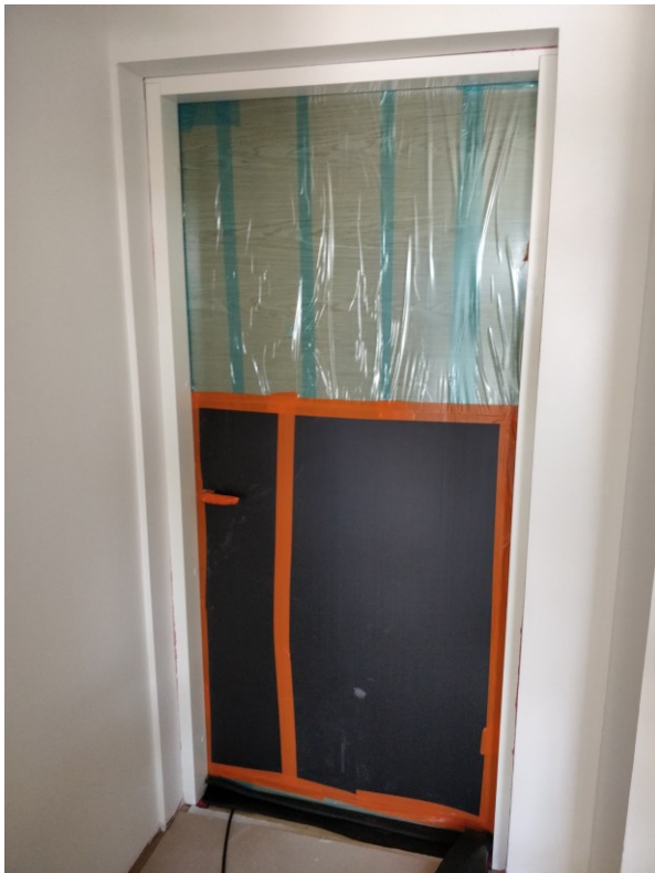
Kuva 16. Ovien tiivistys solukumieristeellä toisella mittauskerralla.
