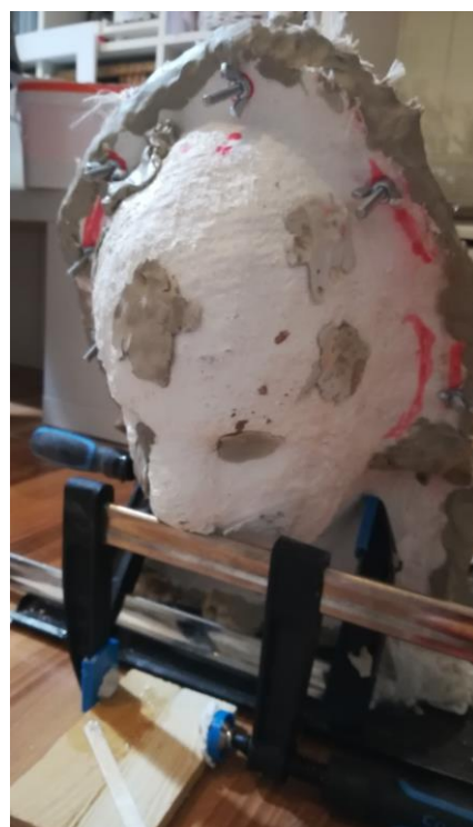
KUVA 23. Savitiivistykset ja peitetyt vuotoaukot
