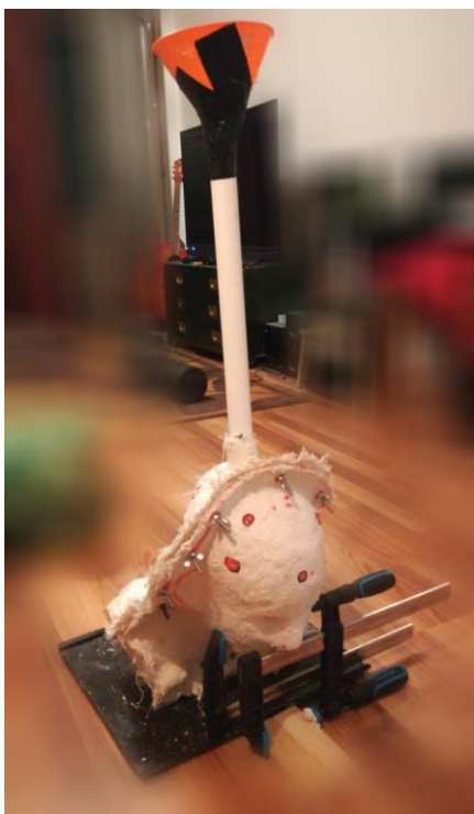
KUVA 22. Muotti puristimissa ja valutuubi kiinnitettynä päälle
